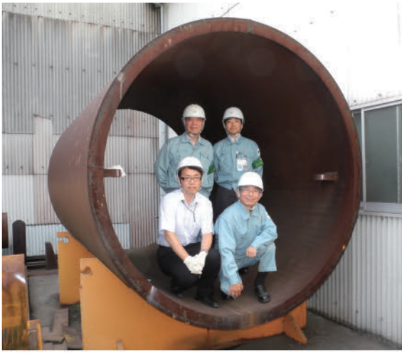
スカイツリーの柱の一部に使われた円形鋼管のサンプル=兵庫県伊丹市、佐々木製罐工業
