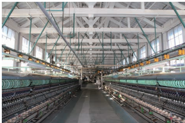
繰糸所の内部。木造のトラス構造が美しい。明るい光が入り、繰糸機が今にも動き出しそうだ＝群馬県富岡市（画像提供富岡市）
